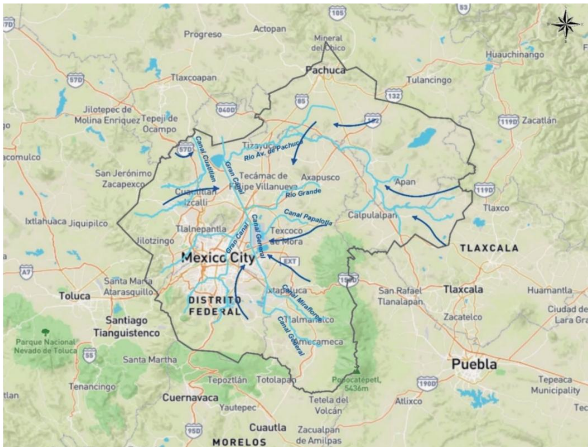
Imagen 18. Esquema del flujo de agua subterránea del Sistema Anáhuac (elaborado con base en las redes de flujo obtenidas de CONAGUA, IMTA, UNAM)
